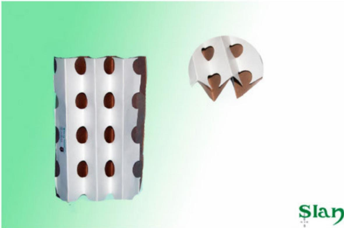
Os filtros de cartão Plissado Slan Filtros são utilizados para filtragem de ar em cabines de pintura. Eles podem ser fabricados tanto em papelão quanto em aço galvanizado. Seu sistema de filtragem utiliza a rápida mudança de direção do fluxo de ar para colidir as partículas em seu interior e armazená-las.
