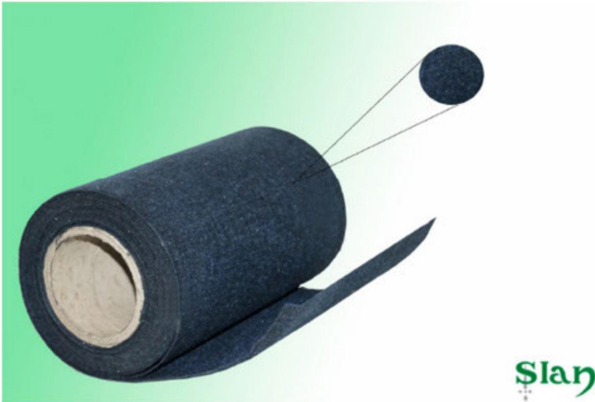
O carvão ativado em manta Slan Filtros é utilizado para remoção dos mais diversos tipos de odores em instalações industriais. Através do processo de adsorção os elementos químicos causadores do cheiro ficam retidos no elemento proporcionando uma grande redução no odor final ocasionado pelo processo industrial. Diferentemente do carvão granulado seu uso é mais restrito a sistemas com menores vazões de ar ou odores mais amenos.
